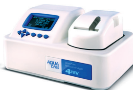
4TEV Měření vodní aktivity. Řízení teploty (rozmezí 15-50°C) Kapacitní senzor.
